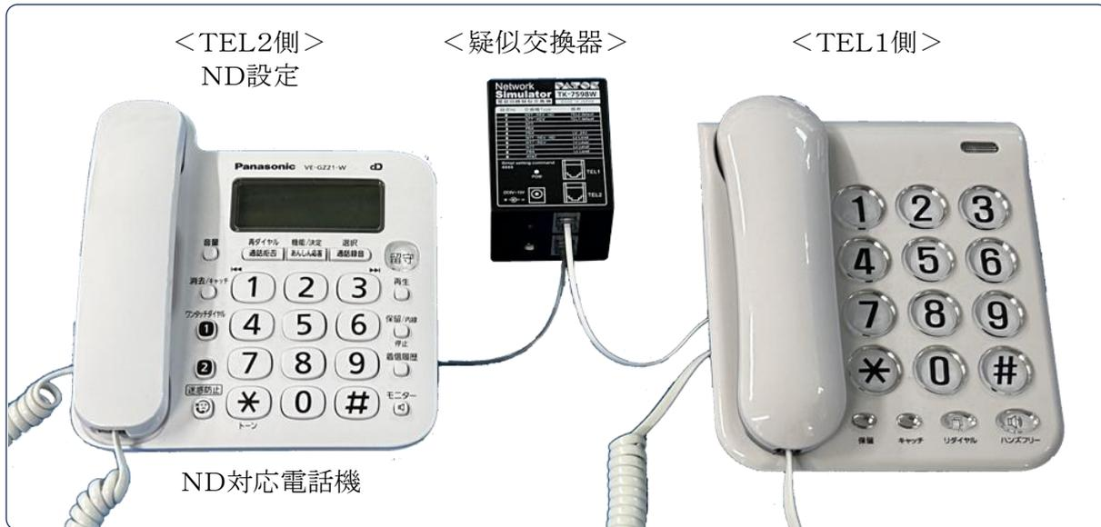
[図6-1] 疑似交換機を介して TEL1 と TEL2の通信（TEL2側にナンバーディスプレイ対応機を接続の例）
