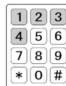
例3) 自動着信後、外線電話機の [1]～[4]に続いて[\*]を押している間、リレー1～4がON
