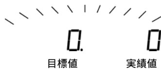
[図12 1]セットモード時の表示器の様子(初期化の状態)
