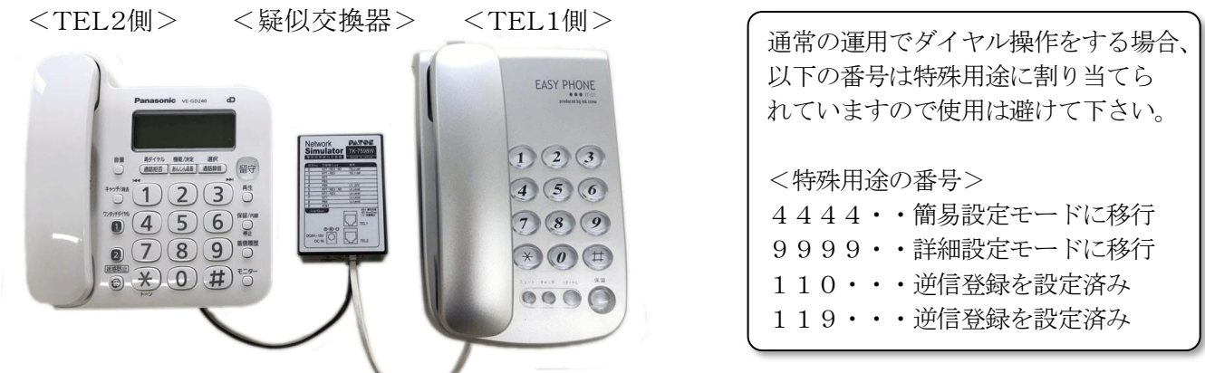
[図6-1] 疑似交換機を介して TEL1 と TEL2の通信（TEL2側にナンバーディスプレイ対応機を接続の例）
